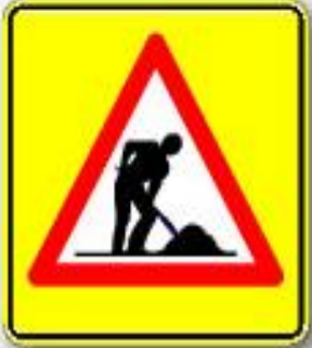
(T-15) YOLDA ÇALIŞMA
