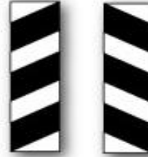
(T-31a,b) KÖPRÜ YAKLAŞIMI (Sağ, Sol)
