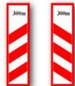
(T-28a,b) DEMİRYOLU HEMZEMİN GEÇİT YAKLAŞIMI (Sağ, Sol)
